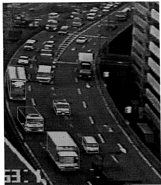
図5 対象とする車両の重なりのある画面 (首都高速道路箱崎区間)
